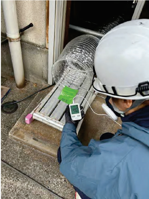
写真5 集じん・排気装置の排ガス出口の風速の測定
